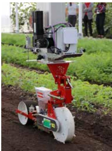
*NéoFarm* expérimente son portique entièrement robotisé, ici équipé d'un semoir, qui soulagera les maraîchers des tâches pénibles et ingrates.
